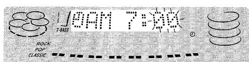
Después de designar la hora de encendido del temporizador, uno de los nombres de las fuentes de sonido parpadeará en el visualizador.
